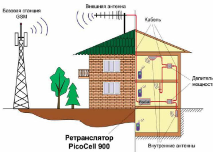
Ретранслятор работает следующим образом.
